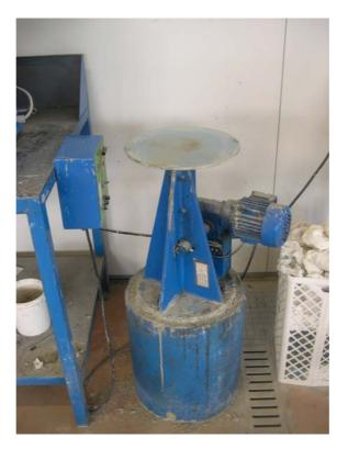
Fig. 2 - Mortar flow table (UNI 7044).
